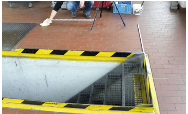
Bild 3: „Normaler“ Fliesenboden, der in der Regel uneben ist (Quelle: GTÜ)
