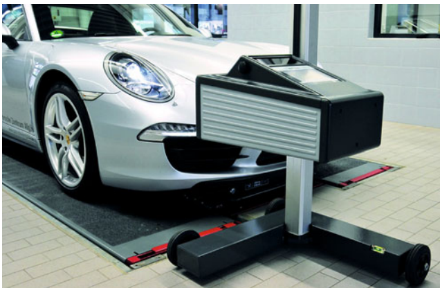
Bild 5: Gerät mit Nickwinkelausgleich (Quelle: maha.de MLT 3000)
