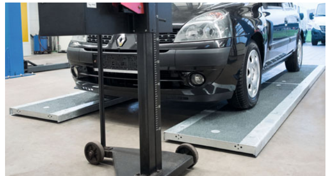
Bild 7: Justierte Auffahrplatten auf Estrich mit „normalem“ SEP (Quelle: rmi-tec.de)
